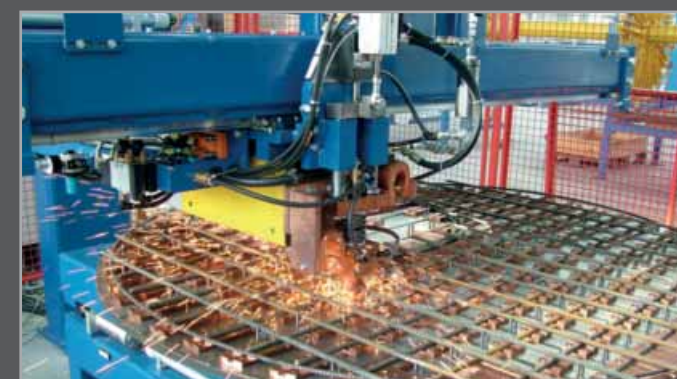
Специальная машина типа GSM для сварки арматурной сетки для оснований колодцев
