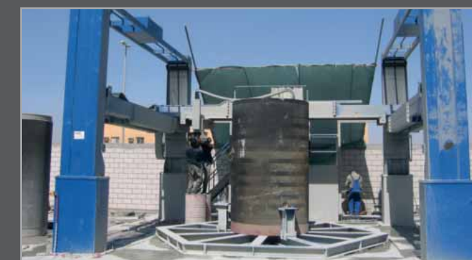
Специальная машина типа VFM для вертикального фрезерования бетонных труб
