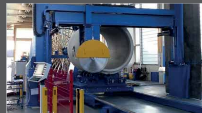
Специальная машина типа PSF для распиловки и фрезерования бетонных труб
